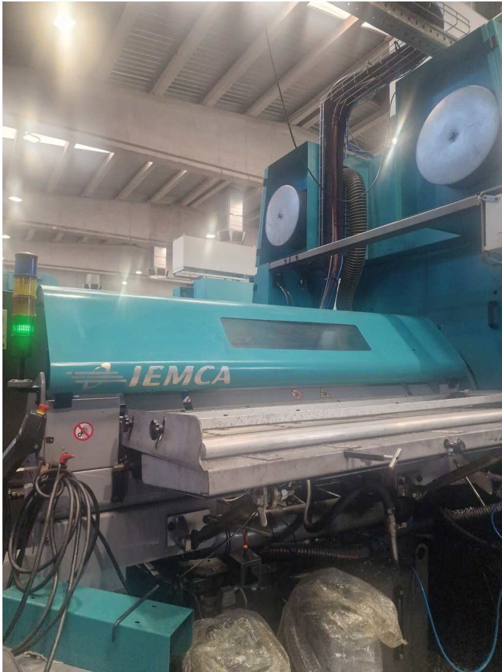
Stangenlademagazin mit sichtbarer IEMCA-Kennzeichnung.
