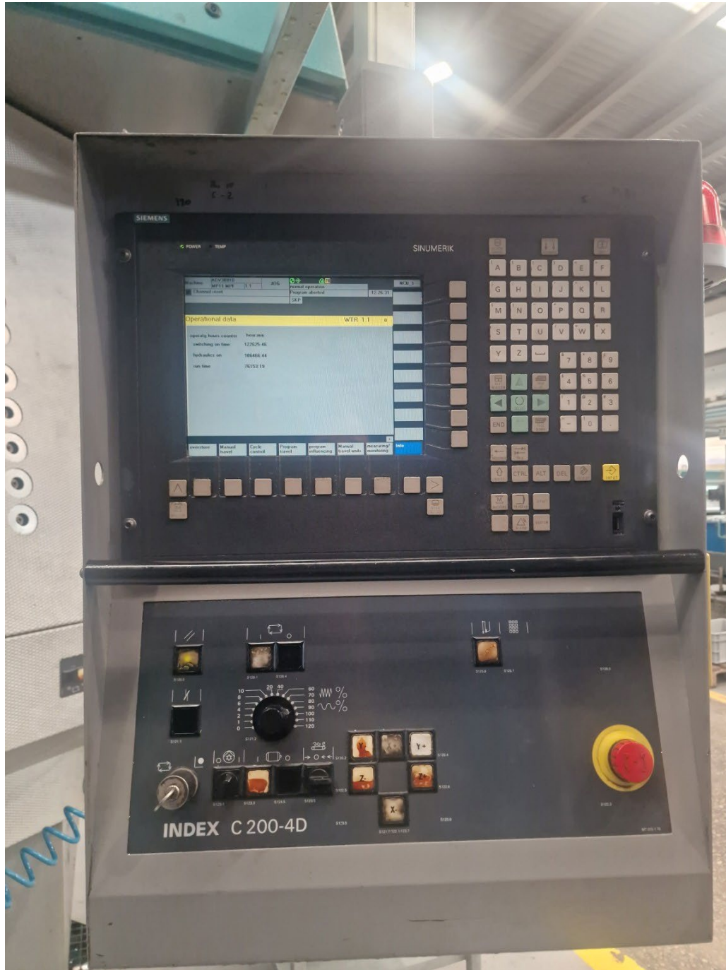
Bedienpult mit Siemens SINUMERIK-Steuerung.
