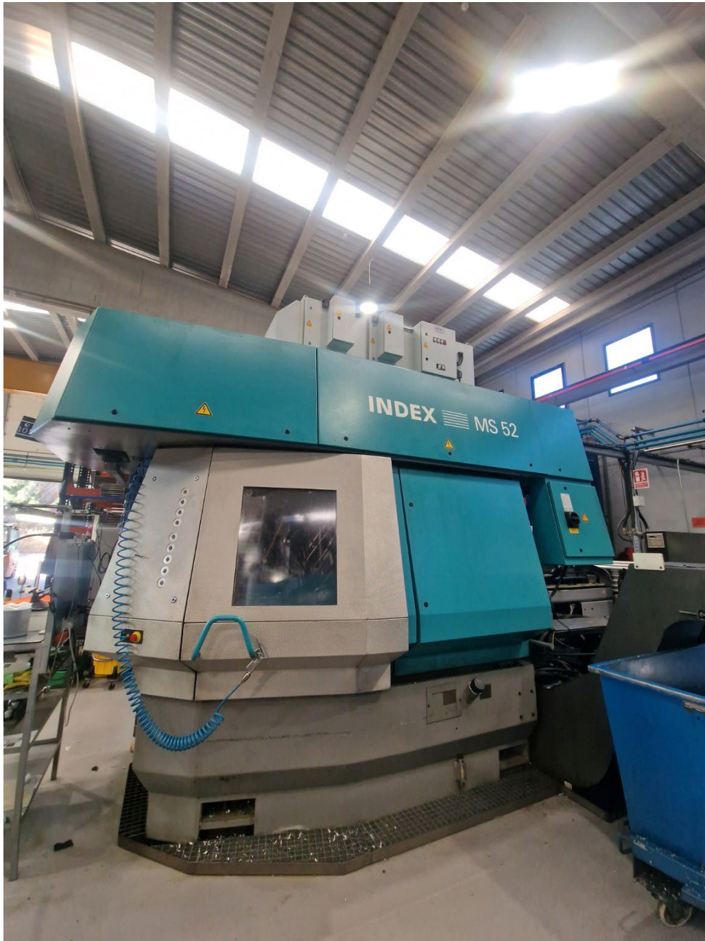
Gesamtansicht der INDEX MS52C mit angeschlossenem Stangenlademagazin.
