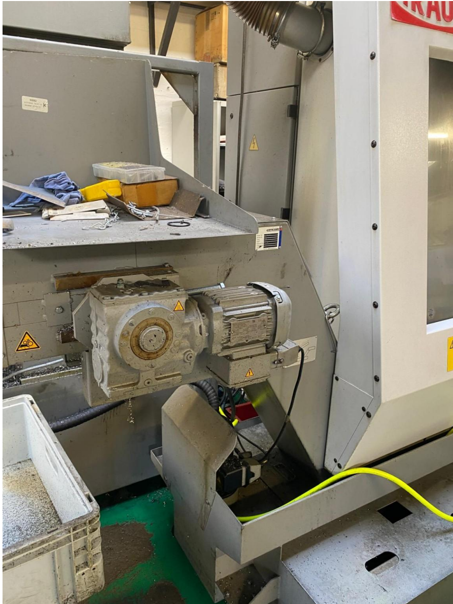
Antrieb des Späneförderers beziehungsweise der Austrageeinheit.
