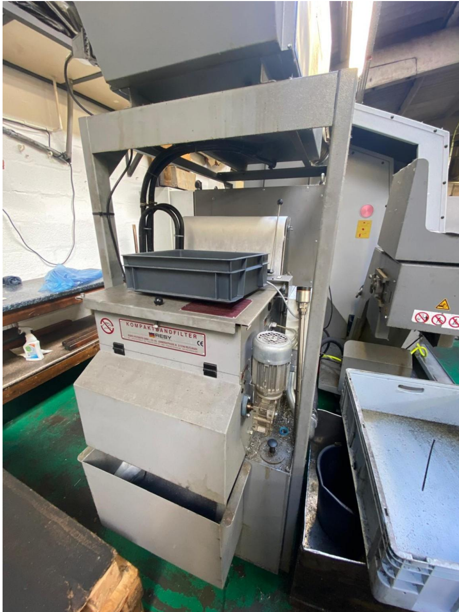
Späneförderer beziehungsweise Austrageinheit an der Maschinenrückseite.
